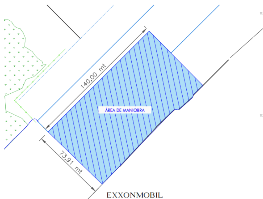
Figura 1. Dársena de maniobras
