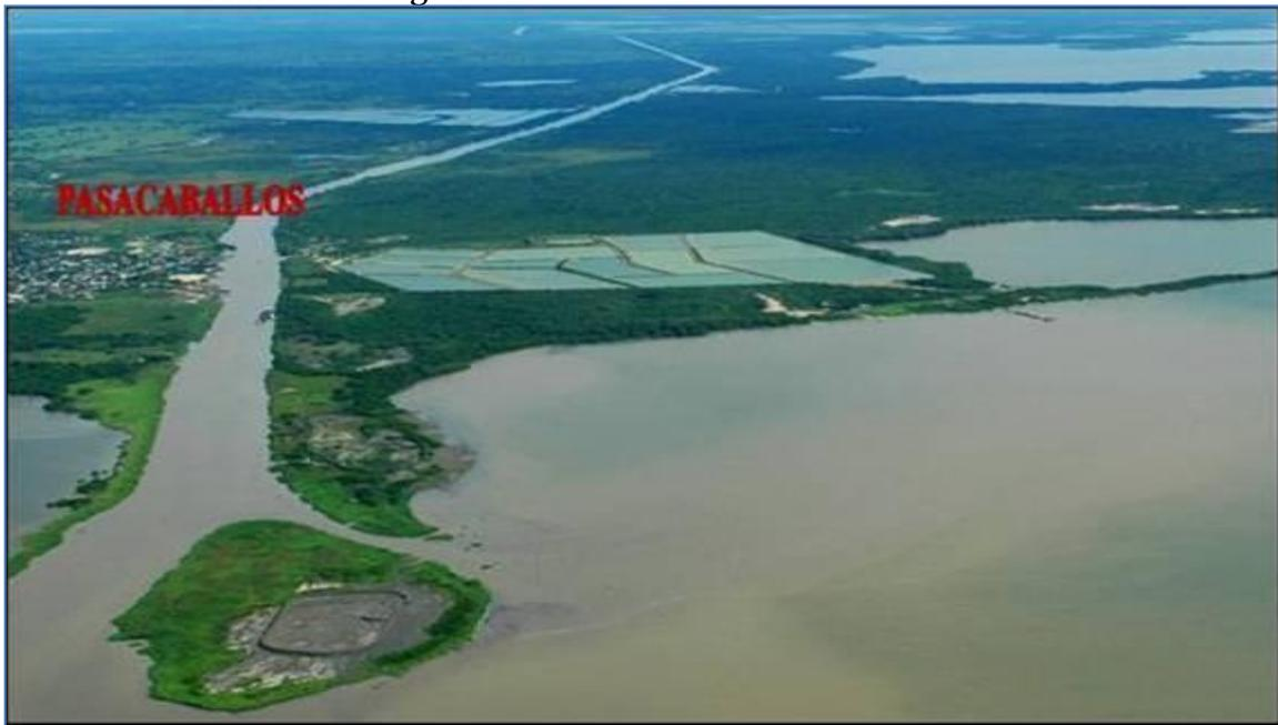
Nota: Obsérvese el avance del delta con la formación de los diques sedimentarios y una isla conformada por el material de dragado. En la parte inferior, se puede ver la piscina botadero. Fotografía facilitada por Alberto Iglesias - Carbones del Carare, 2006.
