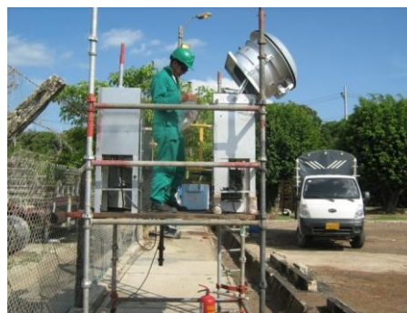
Foto 5.4 Cambio de filtro estación de monitoreo CA3
